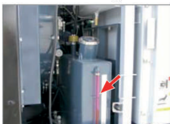
نشانهگر سطح روغن هیدرولیک دریل
