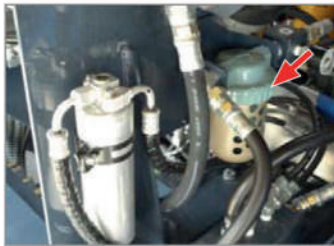
نشانهگر سطح روغن هیدرولیک دریل
